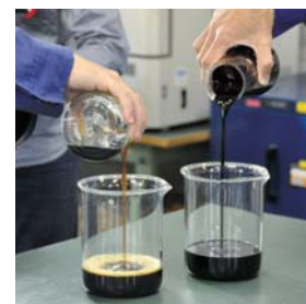
コンデンセート(左)と一般的な原油(右)。コンデンセートは超軽質で粘度が低いため泡立っている。
