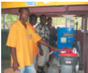
プロジェクトサイト(CIS)に設置された精米機
