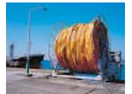
オイルフェンス(格納時)
