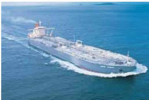
原油の流出を未然に防ぐダブルハルタンカー
