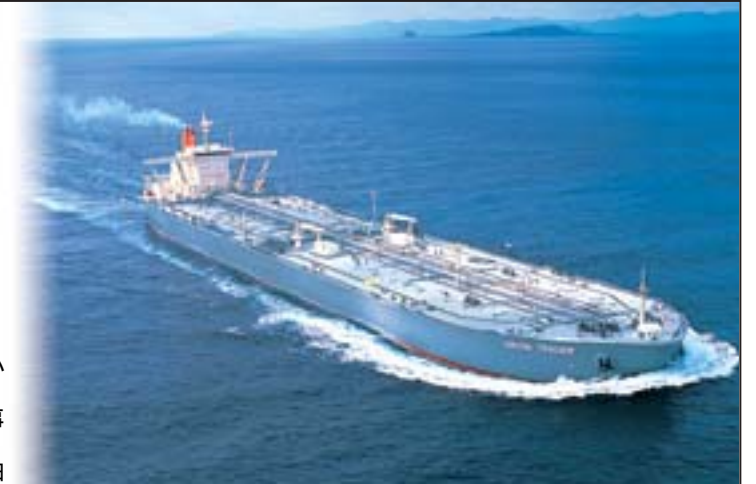
原油の流出を防ぐダブルハルタンカー
