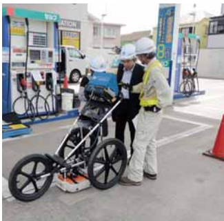
▲ 地中レーダーによる埋設調査
