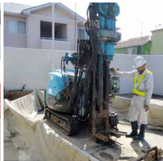
▲ ボーリングによる土壌の採取
