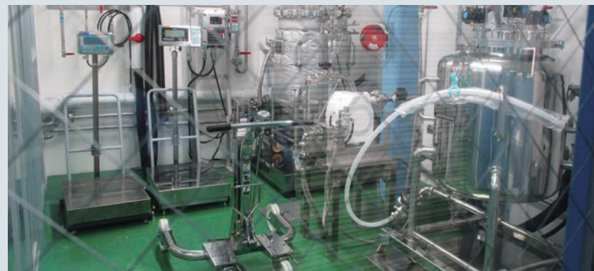
レジスト用ポリマー製造装置(クリーン環境下にて製造)
